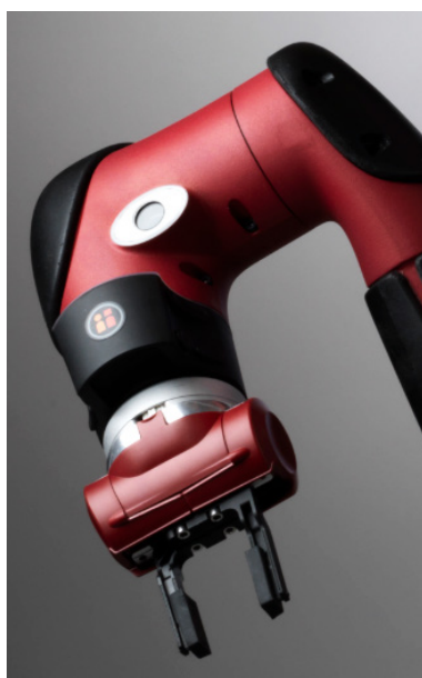
Eingebautes Kamerasystem mit Cognex Kamera
